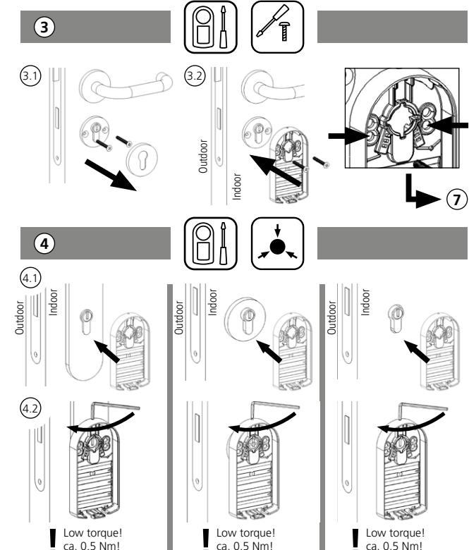
**(de)** Prüfen Sie nach einem Batteriewechsel die Verschraubung der Klemmverbindung, ziehen Sie ggf. nach.
